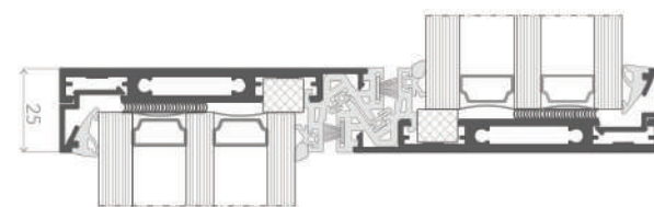
przekrój przez AS 178 PRO SLIM wariant ULTRA
